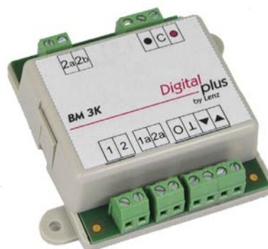
Führt eine mit BM3 eingerichtete Blockstrecke durch eine Kehrschleife braucht man dazu, neben dem LK200 natürlich, ein spezielles BM3 Modul, das BM3K, und davon gleich 2 Stück.
