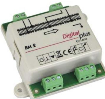
Das BM2 gestattet nicht nur, den Zug bei „Hp 0“ vor dem Signal anzuhalten, sondern bietet zusätzlich die Installation eines Langsamfahrabschnittes für „Hp 2“. Die Strecke vor dem Signal wird in einen Fahr- und einen Bremsabschnitt eingeteilt. Die Länge des Fahrabschnittes muss so bemessen sein, dass der längste dort verkehrende Zug komplett hineinpasst.
