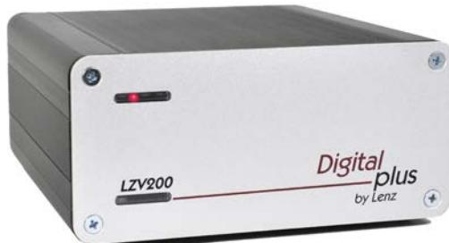
Die LZV200 erledigt Datenverarbeitung und die Verstärkung des Signals. Selbstverständlich entspricht sie den Voraussetzungen für den Betrieb einer Modellbahn. Die Gleisspannung lässt sich zwischen 11 und 22 Volt einstellen, maximal 5 Ampere Ausgangstrom stehen zur Verfügung. Bei zu hoher Belastung schaltet die Sicherheitsschaltung ab. Werkseitig ist eine Ausgangsspannung von 16V und der maximale Strom von 5A eingestellt. Zur Stromversorgung wird ein Trafo TR 150, Art.Nr. 26150, benötigt.
