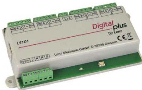
An den Schaltdecoder LS101 können vier Weichen oder Signale usw. angeschlossen werden. An den Ausgängen liegt Gleichspannung an. Dies ist beim Einsatz von Leuchtdioden zu beachten. Über die Klemmen R und S des LS101 wird die für die Rückmeldung der Weichenstellung nötige Verbindung mit der Zentrale hergestellt. Die Weichen- oder Signalstellung wird dann zum Beispiel im Handregler angezeigt oder als Information an ein Steuerungsprogramm weitergegeben.
