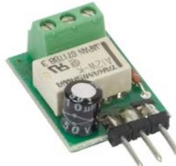
Der BMA Adapter (Adapter für Blockstreckenmodul BM3) ermöglicht den Anschluss von Signalen, die mit einem Doppelspulen- oder motorischen Antrieb ausgerüstet sind, an das Blockstreckenmodul BM3. Technisch gesehen ist der BMA ein Relais, welches von den Lampenausgängen des BM3 gesteuert wird.
