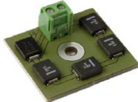
Im einfachsten Fall wird die Gleisspannung zum Bremsabschnitt vor dem Signal über den BM1 geführt. Steht das Signal auf „Halt – Hp0“ erzeugt der BM1 eine Asymmetrie in der ansonsten symmetrischen Digitalspannung: Der Zug bremst sanft bis zum Stillstand ab, wahlweise mit der eingestellten Bremsverzögerung oder dem eingestellten Bremsweg.
